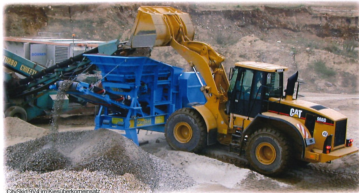
CitySkid 9V4 im Kiesüberkomeinsatz
