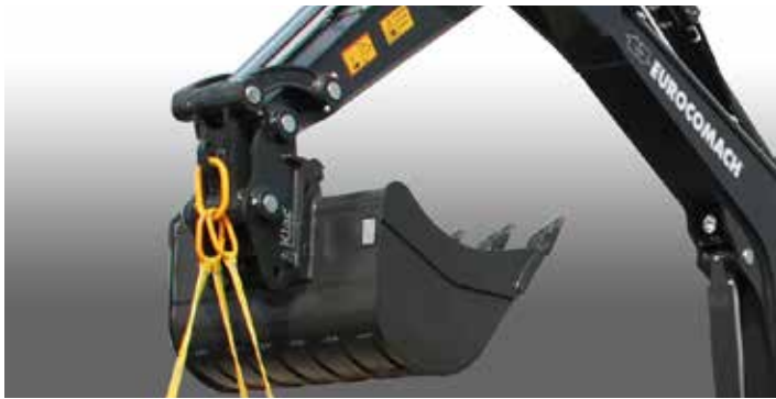
Zertifizierter und homologierter Lasthaken und Sperrventile mit CE-Zertifizierung für die Ausrüstung zur Material-Handhabung
