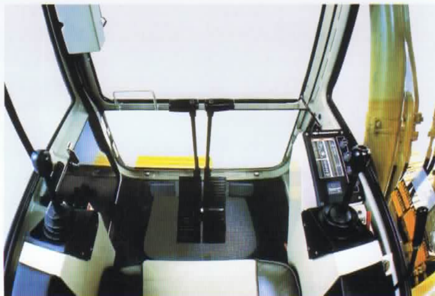
Schwenkwerk und Stielbewegung (linker Hebel)
