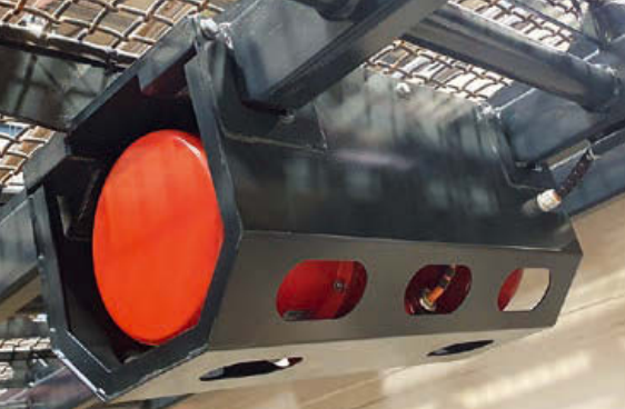
Direkterregung des Siebdecks
