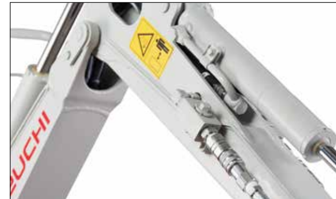
1 Steuerkreis, Betätigung mittels mechanischem Fußpedal.
