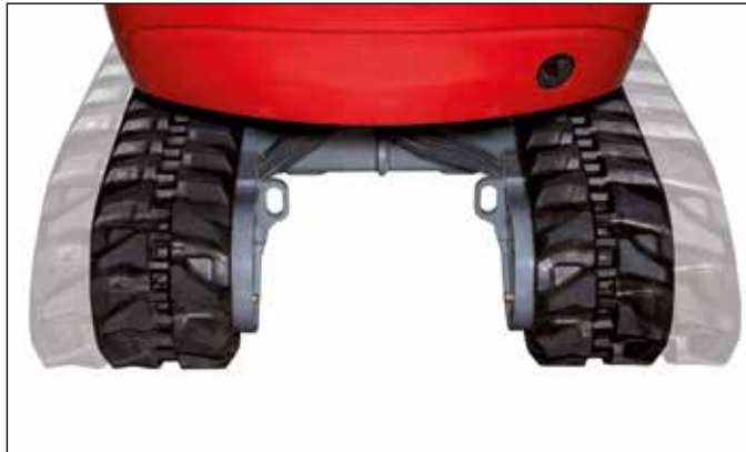
Raupenfahrwerk mit hydraulischer Spurverbreiterung.
