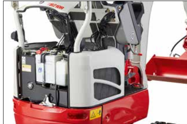
Großzügige Wartungsklappe für servicefreundlichen Zugang zu Motor und Hydraulikaggregat.
