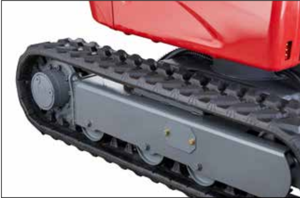
Laufrollen mit Außenführung für sicheren Gummikettenlauf und vibrationsarmes Fahren.
