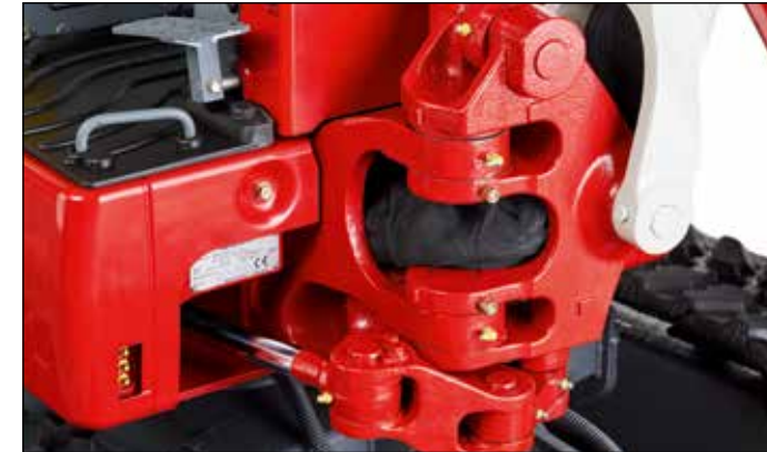
Robuster Schwenkbock mit Schwenkzylinder. Hubzylinder mit Endlagendämpfung.
