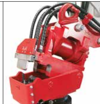
System Huppi-Quick: Hydraulikanlüsse werden beim Schnellwechselvorgang automatisch verbunden
