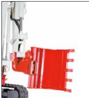
Powertilt mit hydr. Schnellwechselplatte, Tieflöffel als Hochlöffel montiert
