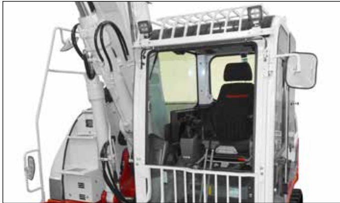
Schallgedämpfte, vibrationsarme Komfortkabine mit Ablagefächern.
