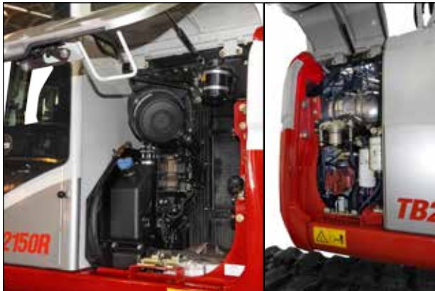
Wartungsfreundlicher Zugang zu den Aggregaten.
