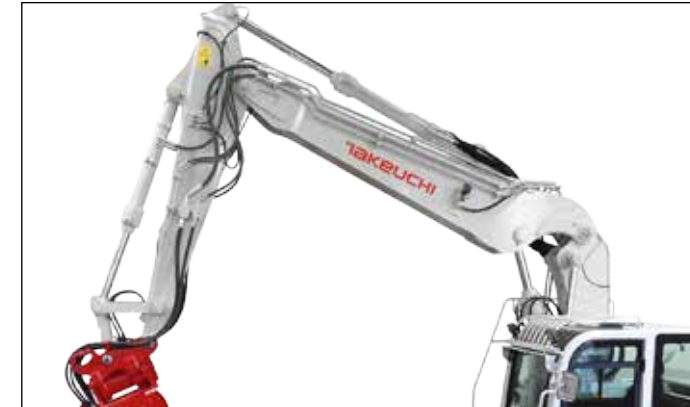
4 Steuerkreise, davon 3 proportional gesteuert, regulierbarer Druck und Literleistung.
