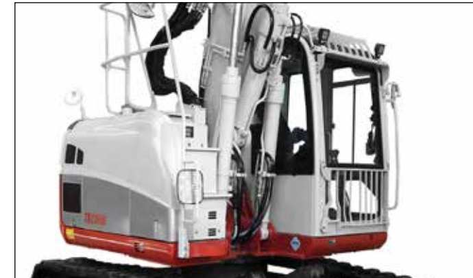
Innovative, außenliegende Schlauchführung bietet besonderen Schutz vor Beschädigungen.
