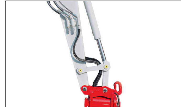
4 Steuerkreise, davon 3 proportional gesteuert. Regulierbare Literleistung, wodurch eine Vielzahl von Anbaugeräten betrieben werden können.
