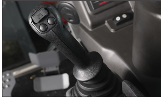
Proportionale Ansteuerung der Zusatzhydraulik über den rechten und linken Joystick.
