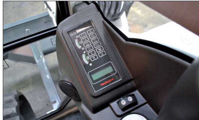
Übersichtliches Display mit optischen und akustischen Überwachungseinheiten. ECO-Modus zur Erhöhung der Wirtschaftlichkeit und Verringerung des Dieselverbrauchs.
