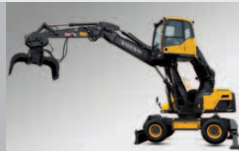
Hydraulisch hochfahrbare Kabine
