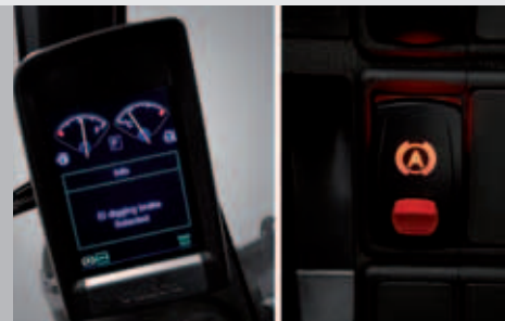
Automatische Betriebsbremse und Pendelachsverriegelung
